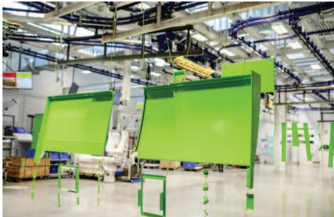
◀ Nová lakovna moderně zabraňuje tepelným ztrátám a využívá i rekuperaci tepla z lakovacích dílů. Uzavřený systém s čistěním a recyklací odpadní vody, pak šetří vodu v objemu cca 16 metrů kubických každé dva týdny.
